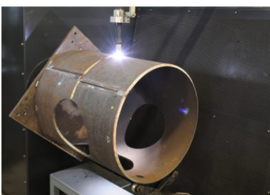
3D plasmasnijder (CNC) in actie
